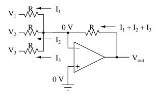
$V_{out} = -(V_1 + V_2 + V_3)$
